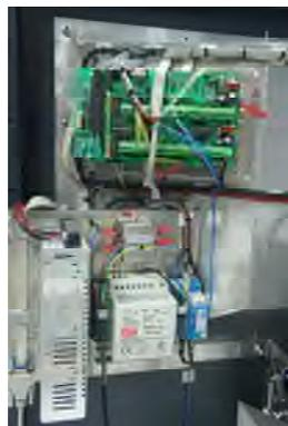
**V4-Controller und Spannungsversorgung.**
