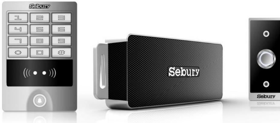
Die Fertigung nach höchsten Qualitätsanforderungen garantiert die dauerhafte Einsatzbereitschaft. Das neue sKey Zutrittssystem besteht aus dem Smart Terminal und dem berührungssensitiven RFID-Leser und Tastatur mit weißer Hintergrundbeleuchtung (Näherungssensor auch schaltbar) und Türgongfunktion. Die Lesereinheit ist wasserdicht gemäß IP65 und kompatibel mit EM4102, MIFARE und HID Transpondern.
