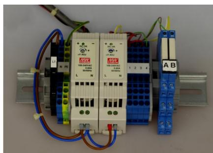
Die I/O-Einheit auf dem Controller hat zwei Relais (NO/COM/NC) und zwei Eingänge für pot.-freien Kontakt. Die Impulszeit ist frei einstellbar.
